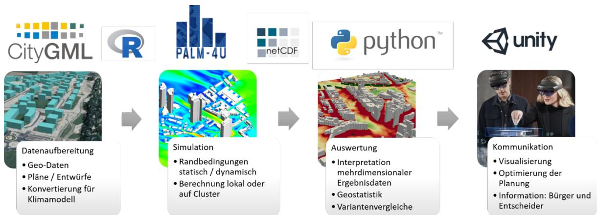
**Abb. 13:** Datenfluss zur Integration und Visualisierung von PALM-4U Modellergebnissen mit 3-D Stadtmodellen in Mixed Reality Anwendungen. Quelle: Fraunhofer IBP
